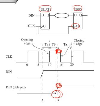
锁存器的时序的第一条规则是:如果数据在锁存器的打开沿之前到达,则寄存器行为将与触发器完全一样。在打开沿捕获数据,而同一时钟沿又将发起数据,作为下一条时序路径的起点。
