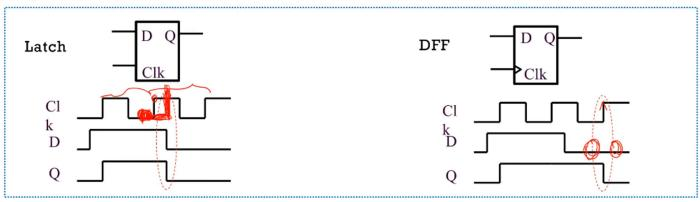
timing borrowing可以给max delay留更多的slack,使setup check更加宽松
